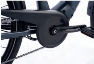
Kein Klemmen, kein Spritzen: vorbildlicher Kettenschutz.
