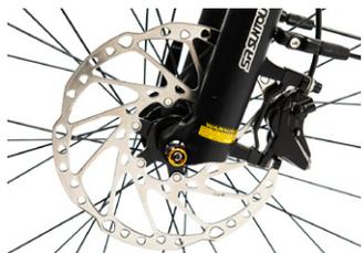
Üppig dimensionierte 4-Kolben-Bremse für viel Sicherheit.
